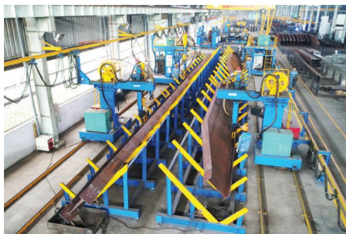
3.2 DÂY CHUYỀN HÀN DẦM H THEO PHƯƠNG ĐỨNG 2
