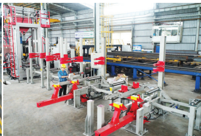
3.3 DÂY CHUYỀN HÀN DẦM H THEO PHƯƠNG ĐỨNG 3
