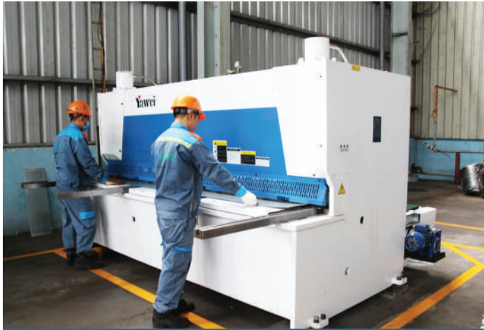
5.1 MÁY CẮT THÉP BẰNG THỦY LỰC 8 MM
