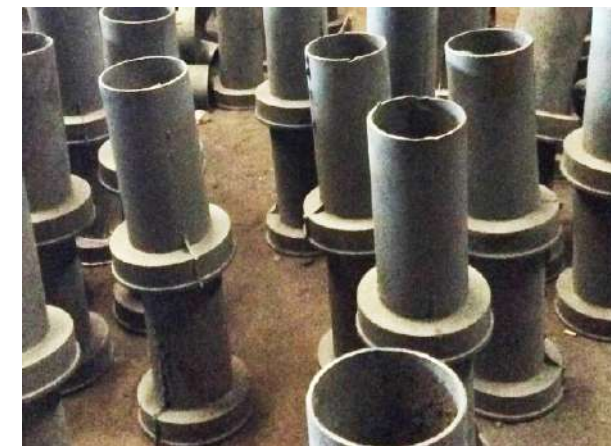
ỐNG THOÁT NƯỚC TRÊN CẦU
