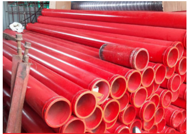
ỐNG BƠM BÊ TÔNG
