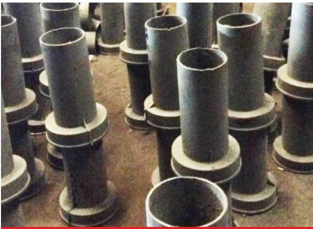
ỐNG THOÁT NƯỚC TRÊN CẦU
