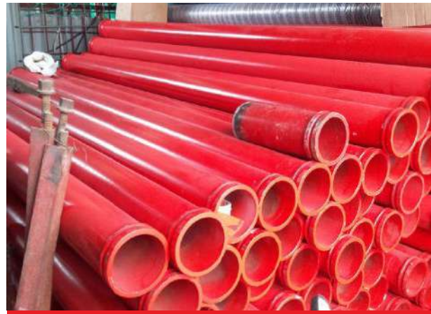
ỐNG BƠM BÊ TÔNG
