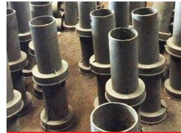
ỐNG THOÁT NƯỚC TRÊN CẦU
